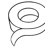
15. Двухсторонний скотч (шириной 20-30 мм), из расчета 15 метров на одну панель Alumoart размером 1200x3000 мм
